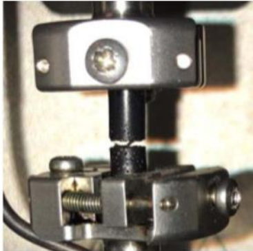
Figuur 5.2 Resultaat uniaxiale trekproef om de cohesieve sterkte van de mastiek te bepalen
